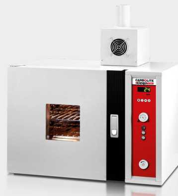
PN 30 mit Feuchtepaket für Trocknungsprozesse
